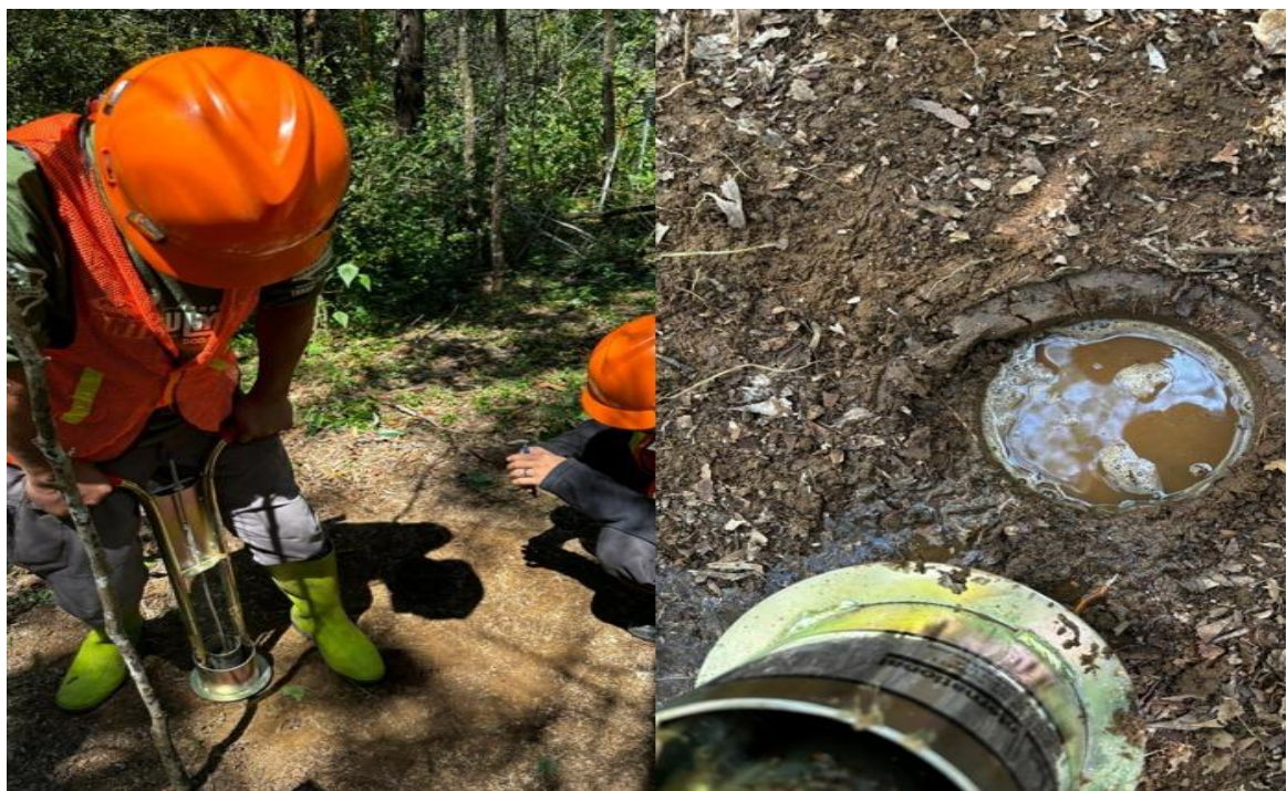
Gambar 2. Pengukuran laju infiltrasi tanah menggunakan Single-ring Turf-Tec infiltrometer
