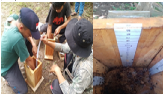
Gambar 1. Pemasangan skala pada bagian dalam dinding stup
